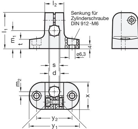
Zylinderschraube DIN 912-M5 Sechskantmutter ISO 4032
